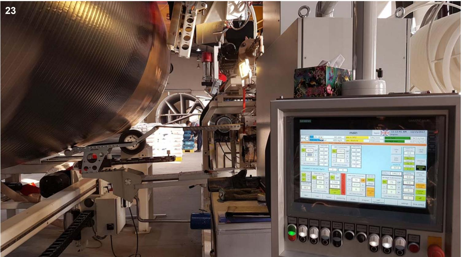
23 La tête de buse pour le tuyau multicouche peut intégrer une fibre de verre ou un fil d'acier dans le profilé PE100 extrudé. La fibre (acier) améliore la résistance à la pression intérieure du tuyau et économise simultanément jusqu'à 50 % de matériau.
