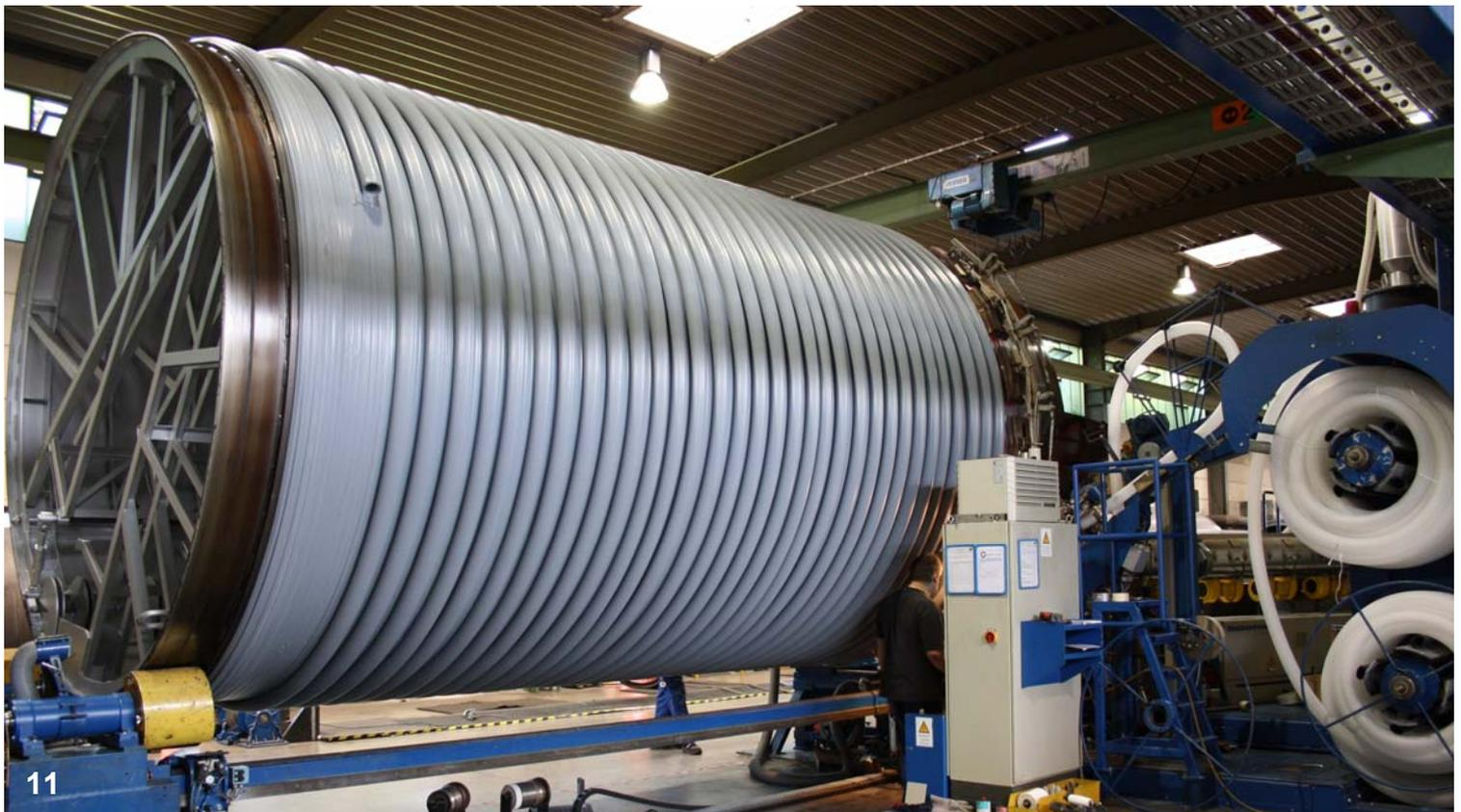
La **technologie à double tête de bauku** permet une production très flexible. La machine peut, en l'espace de peu de minutes, être transformée du profilé plat à paroi pleine en un profil creux rond. L'extrusion de plusieurs couches et le changement des épaisseurs de paroi ainsi que des écartements des profilés permettent une quantité de géométries de paroi pratiquement illimitée.
